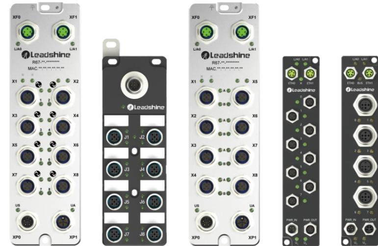
R67系列产品是雷赛智能推出的新一代柜外高防护I/O,防护等级达到IP67,和传统电柜种接线不同,R67产品可无需控制柜直接现场安装,随意安装在工厂的任何地方,推进现场“无柜化”,大大减少布线安装的难度。R67模块支持新一代标准化I/O技术IO-Link,只需要一根三芯非屏蔽线即可完成接线,节省50%接线、维护时间,支持配置参数自动下发,状态监礼省维护成本,缩短停机时间,提高换产效率。同时,R67系列独立式远程模块也采用结构紧凑的工业级金属全密封设计,适用于恶劣的工况环境,具有很强的抗振动和抗冲击能力,广泛应用于晶硅、锂电、医药、汽车、物流、冶金等行业,可直达现场层,助力其高效工程。
