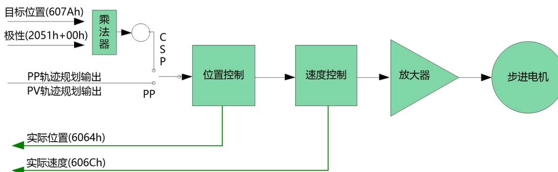
图 7.5 循环同步模式整体结构
