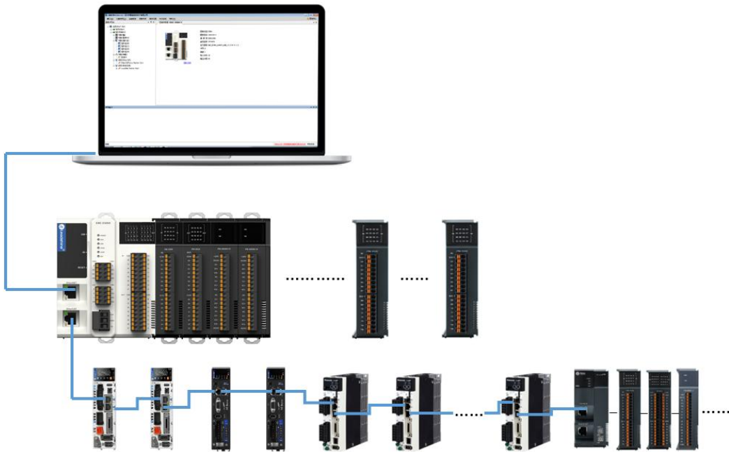
图1.1 EMC3000/5000系列运动控制器典型系统架构
